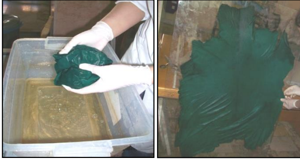
Fotoğraf 26: Tıraşı tamamlanan derinin yıkanması Fotoğraf 27: Derinin kirli cam üzerine serilmesi
