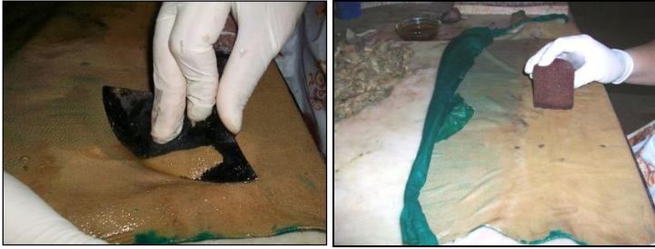
Fotoğraf 22: Tıraş işlemine devam edilmesi Fotoğraf 23: Derinin tıraş sırasında nemlendirilmesi
