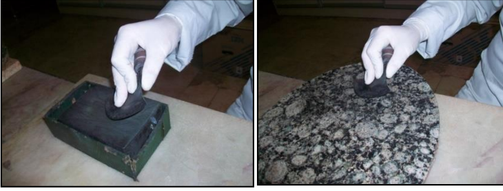
Fotoğraf 20: Bıçkının Girit taşında bileğilenmesi. Fotoğraf 21: Bıçkının ağzındaki kilağının giderilmesi
