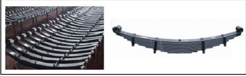
Fotoğraf 6: Araçlarda, bilhassa ağır yük araçlarında amortisör yerine kullanılan, yatsı, hafif yay şeklinde, çelikten yapılan parçadır 70.
